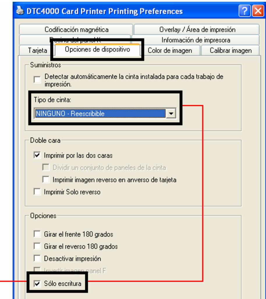
**Precaución:** No se utiliza ninguna cinta con estas tarjetas. No cargue una cinta en la impresora cuando esté utilizando este proceso. Imprimir sobre una tarjeta regrabable con una cinta estropeará la tarjeta.
